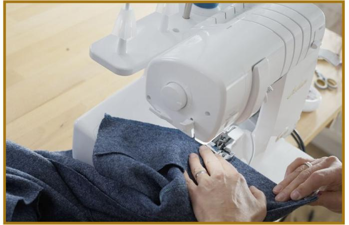
Die Maschine wird nun auf die breite 2-Faden-Flatlocknaht mit Ziergarn in der Nadel umgefädelt und damit die oberen Ärmelnähte (Stoff rechts auf rechts) geschlossen. Nun tauschen wir das Ziergarn gegen ein farblich passendes Overlockgarn und nähen die Manschetten rechts auf rechts an die Ärmel an. Zurück mit Ziergarn in der Nadel werden jetzt die Seitennähte geschlossen. Der Mantel hat auf beiden Seiten einen Schlitz, es wird also nicht bis ganz nach unten genäht.
