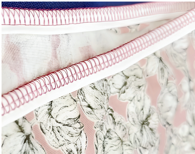
Garn: Normal overlock thread Stichlänge: 4 mm Stichbreite: 7.5 mm
