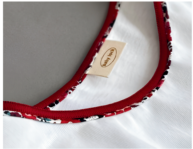
Garn: baby lock thick wooly thread Stichlänge: 2 mm Stichbreite: M
