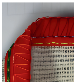
Overlocknaht am Schraegband (Naht)
