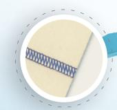
**2-Faden Flatlock**Dehnbare Naht für elastische Stoffe
