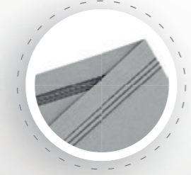
4-Faden Coverstich Elastische Covernaht und schöner Ziereffekt
