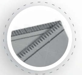
4-Faden Sicherheitsnaht Zusammennähen und Versäubern verschiedener gewebter Stoffe
