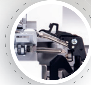
robuste Greiferkanäle mit klappbarem Hilfsgreifer
