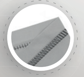
2-Faden Flachnaht Dehnbare Naht und Ziernaht für verschiedene Textilien
