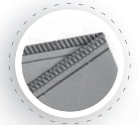
5-Faden Sicherheitsnaht Zusammennähen und Versäubern verschiedener gewebter Stoffe
