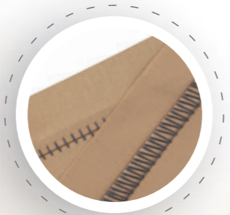
2-Faden Flatlock breit dehnbare Naht und Dekoration
