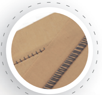
2-Faden Flatlock schmal dehnbare Naht und Dekoration
