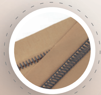
3-Faden Flatlock breit dehnbare Naht für elastische Stoffe
