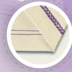
3-Faden Coverstich 3 mm Zum Säumen, Nähen von Biesen und für Ziereffekte
